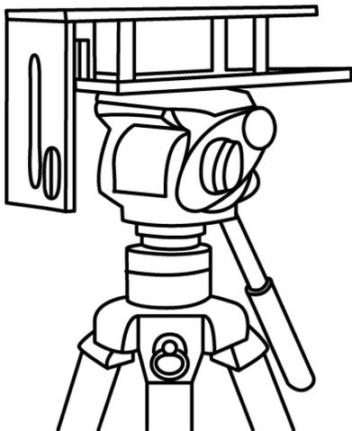
1. プロンプターフレーム金具の底部にあるねじ穴に、お持ちの三脚アダプタを据付け、ねじを締めます。三脚の雲台の上にプロンプターフレーム金具を上にして、三脚アダプタを差込み固定します。プロンプターフレーム金具の垂直なプレートの面が前方を向くように取り付けします。必要に応じて 3/8 インチ→1/4 インチ変換アダプタねじをお使い下さい。
