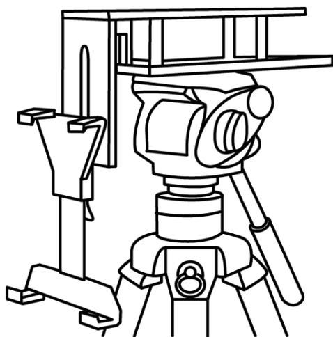
2. 垂直なプレートの正面にタブレットアジャストホルダーをタブレットアジャストホルダー用インチねじ（長）で固定します。
