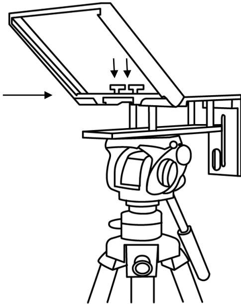
3. プロンプターフレーム金具にガラスフレームをスライドさせ差し込み、2本のガラスフレーム用ミリねじで固定します。
