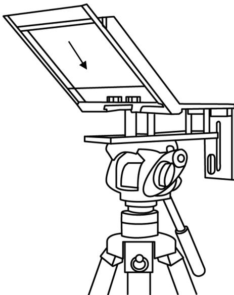
4. 60/40 ガラスをガラスフレームの溝に沿って滑らせます。緑色のシールが向かって右上の角にくるように取付けます。赤いシールはカメラのレンズ側に向けます。
