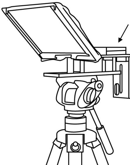
7. カメラのレンズの位置を確認し、ライザーブロックが必要かを決めます。ライザーブロックを使用する場合は、六角穴付ボルトをブロックにねじ込みます。真ん中の穴は使用しないでください。ブロックを裏返すと、ねじは下側に突出します。プロンプターフレーム金具の上部の長い溝に入れます。
