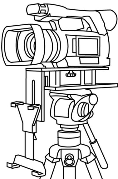
3. プロンプターフレーム金具の上面にあるねじ穴よりカメラ取付用ねじ（短）を使用して、カメラをフレームに固定してください。カメラレンズが良い位置になるように、カメラのポジションを調整してください。
