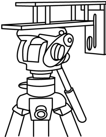
1. プロンプターフレーム金具の底部にあるねじ穴に、お手持ちの三脚アダプタを据付け、ねじを締めます。三脚の雲台の上にプロンプターフレーム金具を上にして、三脚アダプタを差込み固定します。必要に応じて3/8インチ→1/4インチ変換アダプタねじをお使い下さい。
