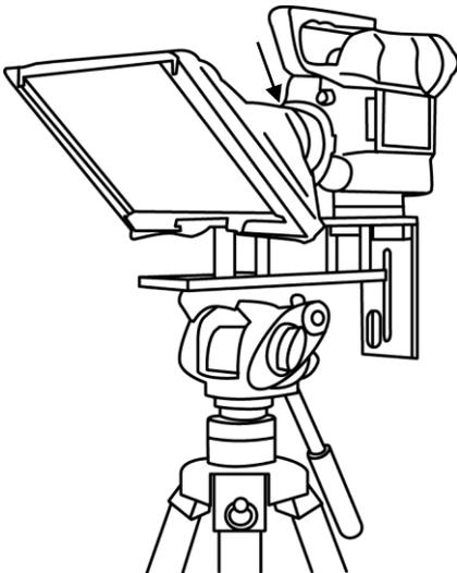
10. プロンプターフードの開閉用の紐を引っ張りカメラのレンズのまわりにプロンプターフードを固定します。プロンプターフードでカメラ側からの光を遮断します。
