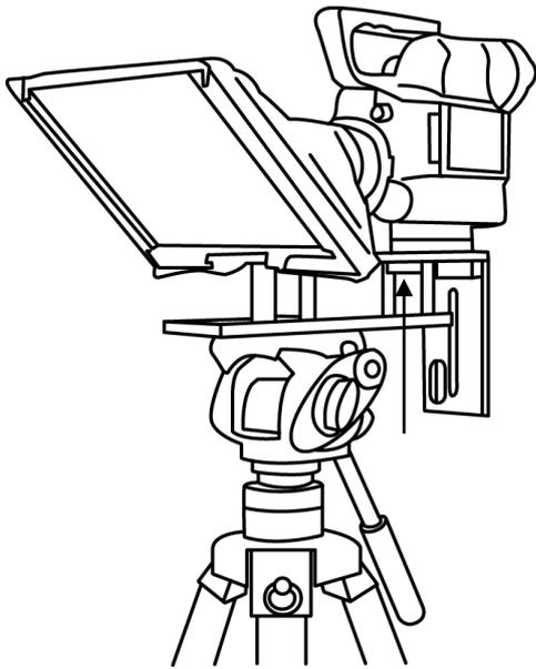
8. カメラ取付用ねじをプロンプターフレーム金具の溝の下からライザーブロックの真ん中の穴を通してカメラの底部に合わせます。カメラをライザーブロックとプロンプターフレーム金具に固定します。
