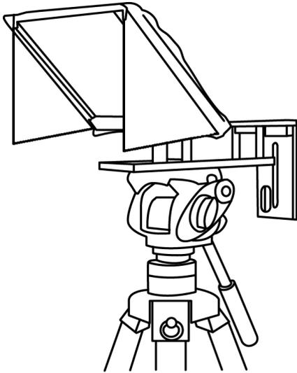
6. 直射日光が 60/40 ガラスまたはタブレットに反射することを防ぐため、サイドのフードを取付けます。プロテクターフードとガラスフレームの間に、マジックテープで固定します。
